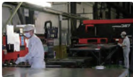
鋼板打ち抜き（鋼板に穴開けや切り欠きを行います）、鋼板曲げ、ネジ溶接、金具溶接、溶接組み付け（鋼板同士を溶接して箱体をつくります）、仕上げをします。
