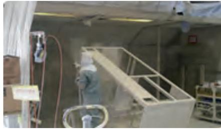
前処理として、板金完成品の脱脂洗浄と防錆皮膜化成処理をし、水切り乾燥をして残った水分を乾燥させます。
