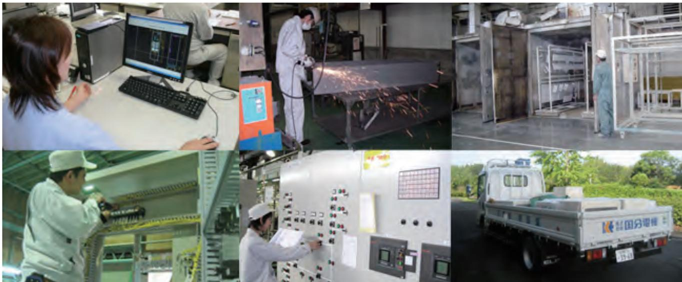
当社は高低圧配電盤・制御盤・分電盤・PDU等をお客様の仕様に合わせて、オーダーメイドにて製作している会社です。設計・板金・塗装・組立・検査・アフターサービスまでトータルで手掛けており、お客様の要望に沿って柔軟に対応しております。
